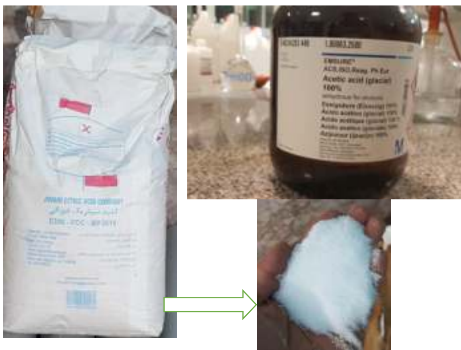
شکل ۴-۶ دو نمونه منبع کربن آلی مورد استفاده در پایلوت شامل اسید استیک آزمایشگاهی و اسید سیتریک
