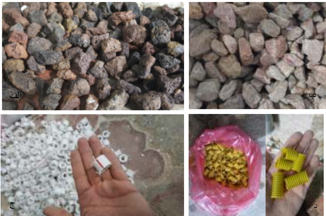
شکل ۴-۵ نمونه مدیاهای مختلف مورد استفاده در چهار بیوراکتور پایلوت ( الف: سنگ پامیس، ب: گراول رودخانه ای، ج: پلی پروپیلن و د: پلی اتیلن)
