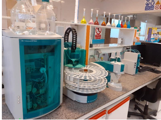
شکل ۳-۴- دستگاه IC مورد استفاده برای اندازه گیری میزان سولفات ( SO_4^{2-} )
